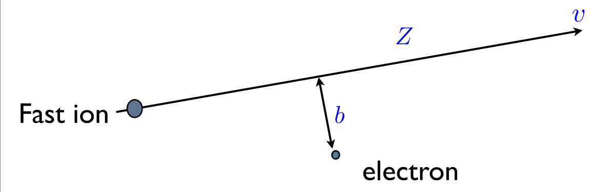
Impact parameter bIon velocity vIon charge Z
