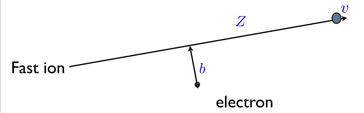
Impact parameter bIon velocity vIon charge Z
