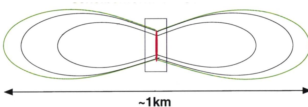
Scheibenförmige Ausbreitung  $\rightarrow$  Drucksignal  $\sim \frac{1}{\sqrt{r}}$
