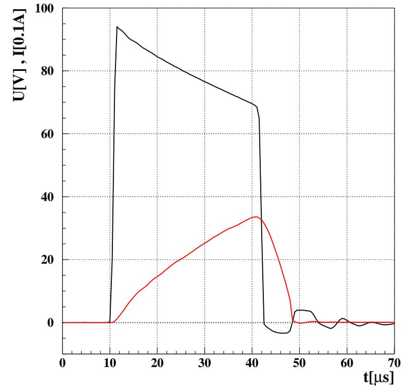
Im Draht deponierte Energie  $\approx 5 \text{ mJ} \equiv 31 \text{ PeV}$
